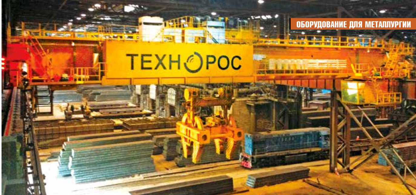
Кран мостовой специальный с управляемыми клещами КМЭСП 150/110-34-А7, склад слэбов НЛМК
