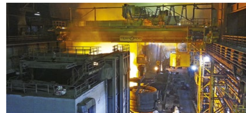
Мостовой металлургический кран 120+32 / 10-24,5-A8, У2 Заказчик: ОАО «Белорусский металлургический завод»
