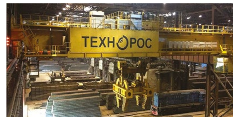
Кран мостовой специальной клещевой 150 / 110-34-А7, Заказчик ОАО «НЛМК»
