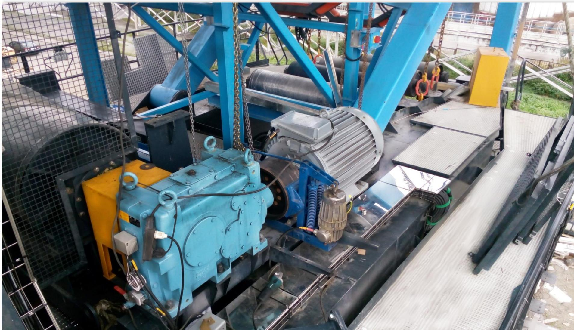
Привод конвейера унифицирован с приводом конвейера соседней судопогрузочной машины – ROXON, а также установлен идентичный редуктор, что уменьшает номенклатуру ЗИП.
