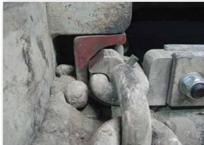
Универсальное скребковое крепление позволяет повторное использование скребков, а также применения длинных отрезков цепи
